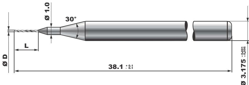
**MD** $\varnothing 0.05 \sim \varnothing 0.15$  mm**MC** $\varnothing 0.105 \sim \varnothing 0.25$  mm**MV** $\varnothing 0.105 \sim \varnothing 0.15$  mm**MCV** $\varnothing 0.12 \sim \varnothing 0.25$  mm**MCW**
